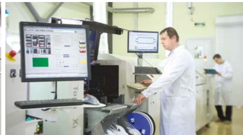
Цех SMT монтажа. Используются компоненты от ведущих мировых производителей. Максимальная производительность до 75 000 компонентов в час.
