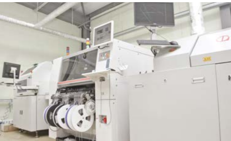
Цех SMT монтажа. Используются компоненты от ведущих мировых производителей. Максимальная производительность до 75 000 компонентов в час.
