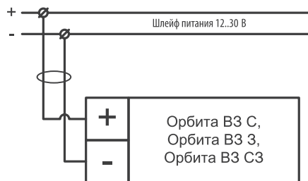
Схема подключения оповещателей Орбита В3
