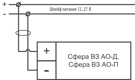
Схема подключения аварийных светильников Сфера V3 AO - Д, Сфера V3 AO - П
