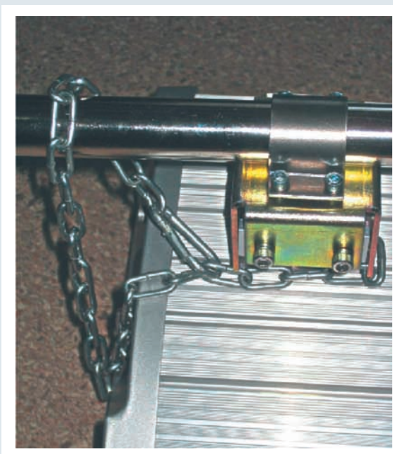
Рис. 7. Монтаж предохранительной цепи на ССП01
