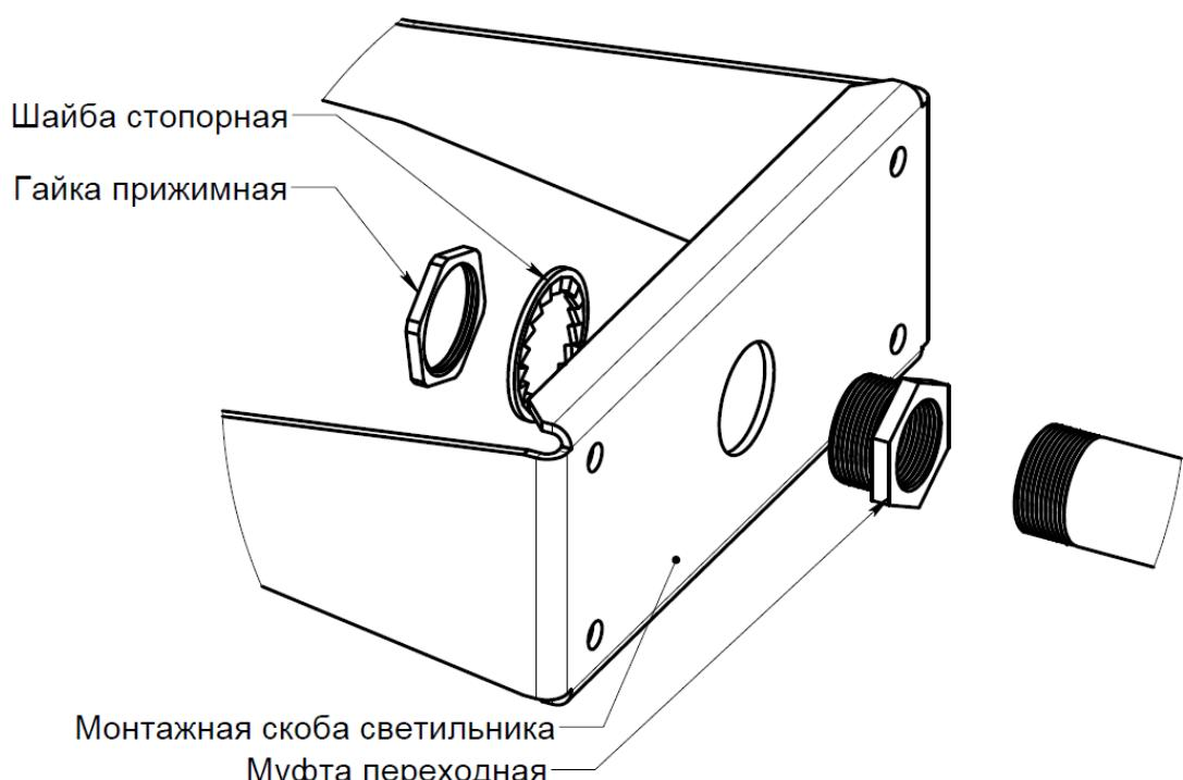
Муфта переходная может комплектоваться шайбой и гайкой или двумя гайками.
