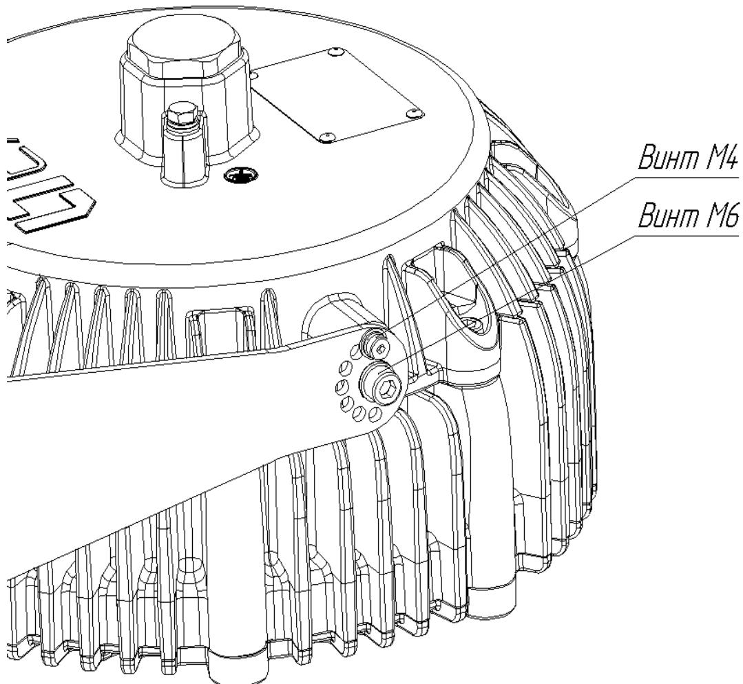
Схема установки муфты.
