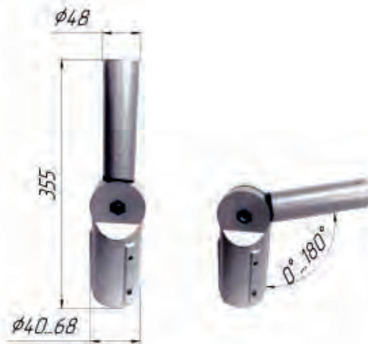
Рис. 4. Поворотный кронштейн для светильников с консольным креплением
